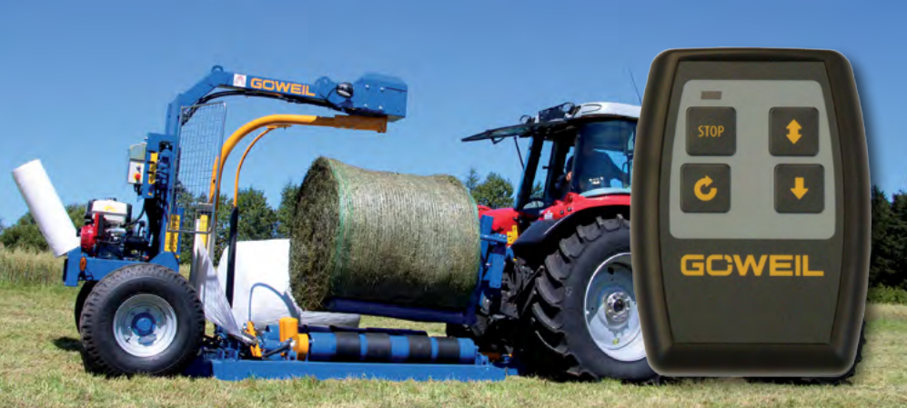
Álló üzemmód rádióvezérléssel és benzinmotorral
